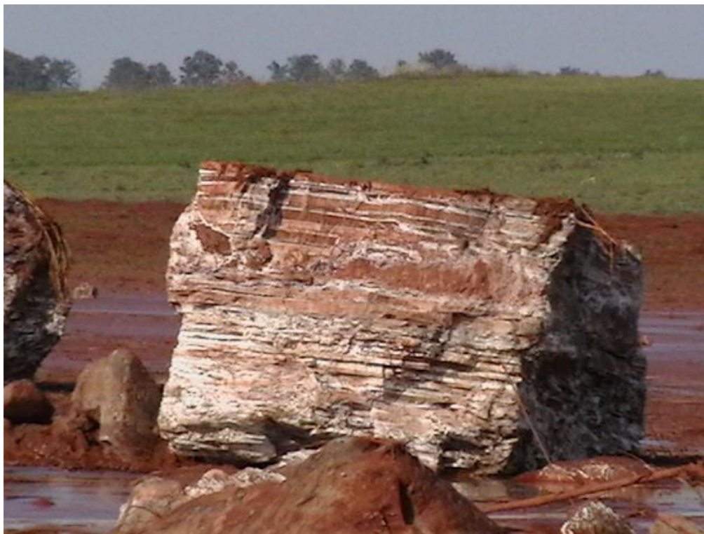
14. ábra. A homokrétegeket jelző fehér csíkok a kötenger egy több köbméteres tömbjében a szakadástól mintegy 300 m-re
